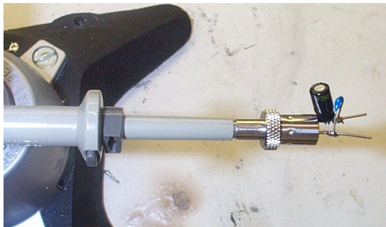
그림 46 - 프로브 마스터( www.probemaster.com ) 4987A BNC 어댑터가 있는 오실로스코프 프로브(리플 측정을 위해 전선으로 개조, 두 개의 병렬 디커플링 커패시터 추가)
