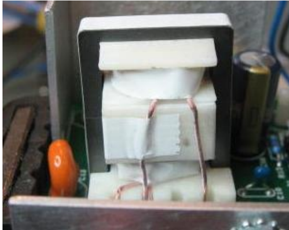
그림 49 - 트랜스포머 전면 실제 사진
