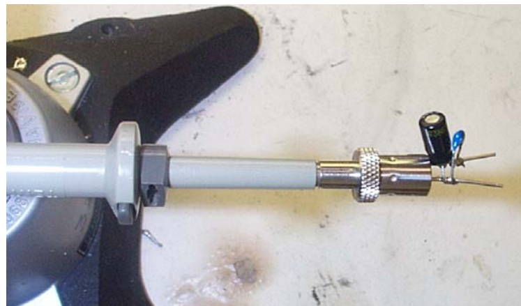
图46 - 附加Probe Master ( www.probemaster.com ) 4987A BNC适配器的示波器探头。（使用纹波测量用导线进行了改装，添加了两个并联的去耦电容）
