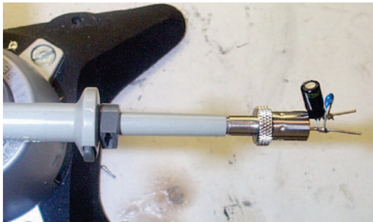
图26 – 附加Probe Master( www.probemaster.com ) 4987A BNC适配器的示波器探头。 （使用纹波测量用导线进行了改装，添加了两个并联的去耦电容）
