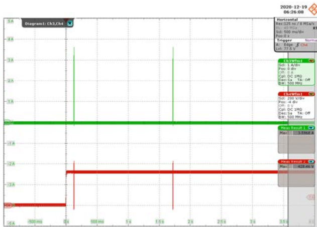
Figure 80 – 230 VAC 60 Hz. CH3: I_{DS} , 1 A / div., 500 ms / div. CH4: V_{DS} , 100 V / div., 500 ms / div. V_{DS(MAX)} = 428.46 V, I_{DS(MAX)} = 3.60 A.
