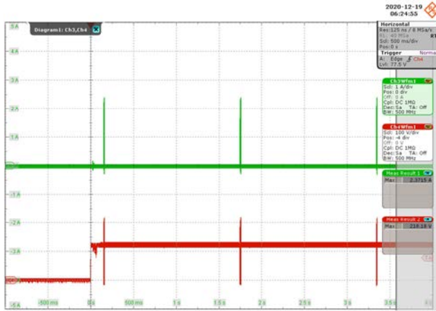
Figure 78 – 90 VAC 60 Hz. CH3: I_{DS} , 1 A / div., 500 ms / div. CH4: V_{DS} , 100 V / div., 500 ms / div. V_{DS(MAX)} = 218.18 V, I_{DS(MAX)} = 2.37 A.
