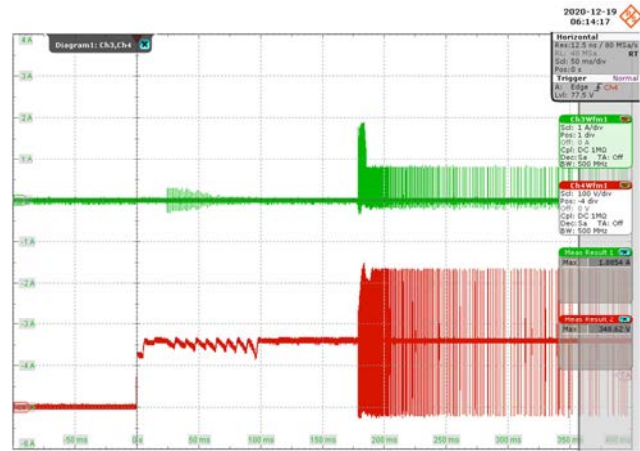
Figure 59 – 115 VAC 60 Hz. CH3: I_{DS} , 1 A / div., 50 ms / div. CH4: V_{DS} , 100 V / div., 50 ms / div. V_{DS(MAX)} = 348.62\text{ V} , I_{DS(MAX)} = 1.89\text{ A} .
